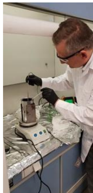
Dozowanie neutralizatora do próbki gorącego asfaltu.
